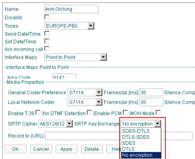
Für die Nutzung der Softphone Funktionen (SIP) ist es **zwingend erforderlich**, in der Gateway-Einstellung des Amtsanschlusses die Einstellung „No encryption“ bei „SRTP“ zu aktivieren.
