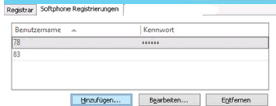
Alle SIP-Leitungen müssen in dieser Verbindungseinstellung hinzugefügt werden.
