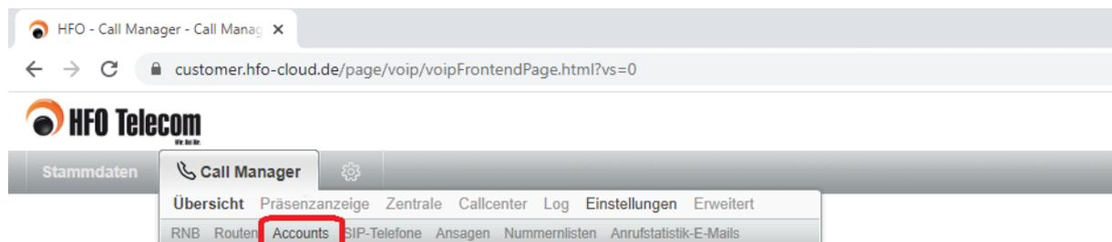
Nach Auswahl des *Accounts*-Menüs steht ein weiterer Menüpunkt *SIP-Accounts* zur Verfügung, über den die eingerichteten SIP-Accounts aufgelistet sind. Wird ein SIP-Account zur Bearbeitung geöffnet, können die Angaben ermittelt werden, die für die Einrichtung der SIP-Leitungen in der estos UCServer Verwaltung erforderlich sind:
